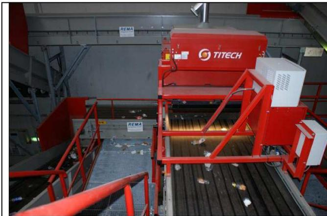
Im nächsten Teil der Anlage ermöglichen hochauflösende, optische Sensoren eine Trennung nach Farbe und Material von Objekten bis herunter zu 10 mm Größe. Im ersten Schritt werden die Kunststoffe nach Materialart wie z.B. PET (Getränkeflaschen aus Polyethylenterephthalat), HDPE (Kosmetik- und Haushaltsflaschen), PS/PP (Joghurtbecher), LDPE (Folien) und Tetrapack erkannt und getrennt.
