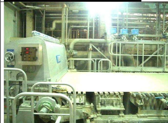
Beim Stoffauflauf werden die Fasern auf ein Siebband aufgebracht, bei dem das Wasser mit Unterdruck (Vakuumpumpen) entzogen wird.
