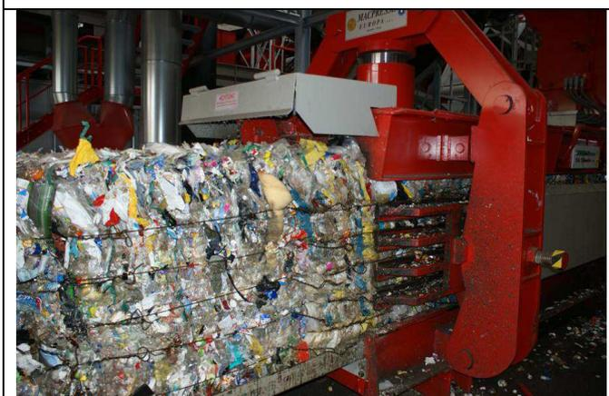
Das sortierte Plastik kommt zuletzt in einen Puffercontainer und wird von einem Perforator zerstochen, damit überall die Luft rausgeht wenn es in die hydraulische Kanalballen-Pressse kommt. In großen Würfeln gepresst wird der Kunststoff dann weitertransportiert.
