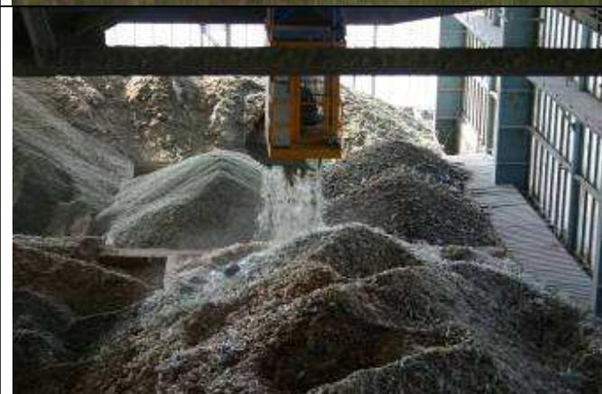
Vor der Schmelze wird das Altglas gründlich aufbereitet, das heißt von fremden Stoffen und Schmutz befreit. Störstoffe wie Metall werden über Abscheider (die z.B. mit Magneten arbeiten) herausgeholt, anderer Müll wird händisch aussortiert.
