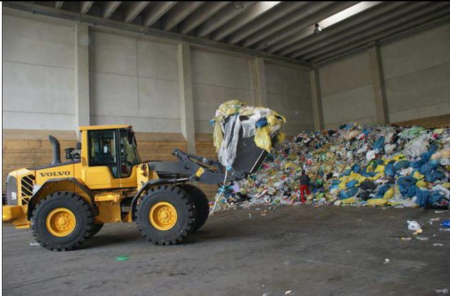
Der dort ankommende Kunststoff-Abfall wird von einem Rollader in die technische Anlage gekippt. Kunststoff-Verpackungen kommen durch den automatischen Sackaufreißer, da sie meist in Säcken gesammelt werden.
