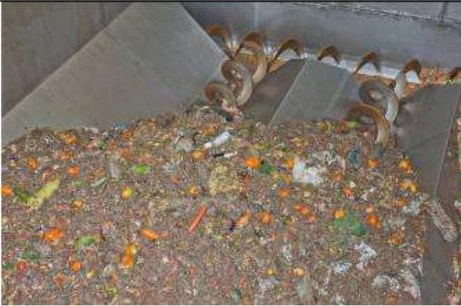
Biomüll, der nicht der Kompostierung zugeführt wird, kommt in die Substratanlage. Hier wird das Substrat, also das flüssige Material für die Biogasanlage vorbehandelt, wo aus Küchenabfällen Strom erzeugt wird. Der Biomüll ist ja oft noch in Säcken, die aufgerissen werden müssen. Dazu befördern Schnecken, die wie Mixstäbe funktionieren, das Material am Boden des Annahmehunkers weiter.
