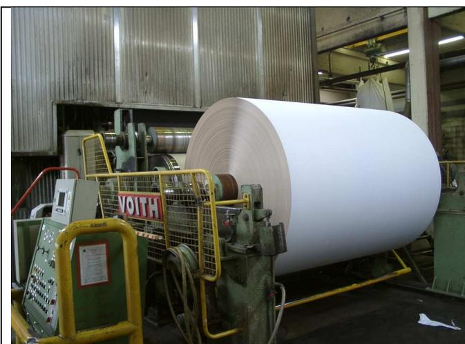
Am Ende wird das getrocknete, gewalzte Papier aufgerollt. Die Rolle wird Tambour genannt und kann zwischen 2,5 und 9 m breit sein. In dieser Form wird das Papier in die Druckerei geliefert oder direkt im Werk zu Karton oder Wellpappe weiterverarbeitet.
