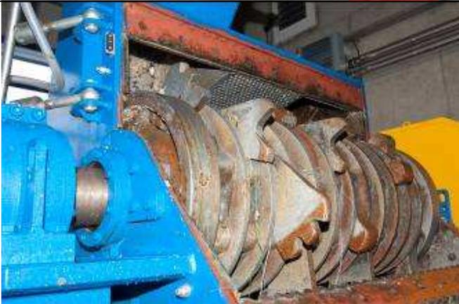
Sämtliche Störstoffe können über mechanische Zerkleinerung mit Hämmern und zusätzlicher Rotation des Trommelsiebes ausgesondert werden. Was nicht weich oder flüssig genug ist, um durch das Sieb gepresst zu werden, wird in einen Container ausgeschieden. Die Hammermühle kann zum Beispiel auch den Kaffee-Sud aus Nespresso-Kapseln holen, und das Aluminium abscheiden.
