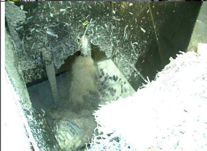
Im Werk kommt das angelieferte Altpapier in eine Auflösetrommel, einen so genannten Pulper. Hier wird das Papier mit Wasser vermischt und zu Brei gemacht.
