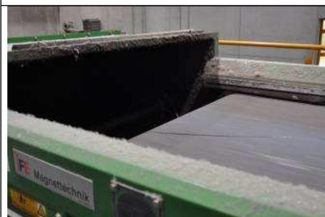
Zuletzt wird mit dem Magnetabscheider alles aussortiert was aus Metall ist. Das macht noch etwa 2-3% der angelieferten Menge aus und kommt per Container zu weiterverarbeitenden Firmen. In Tirol fährt das zum Beispiel nach Hall, wo bei der Firma RAGG auch unsere gesammelten Metallverpackungen landen.
