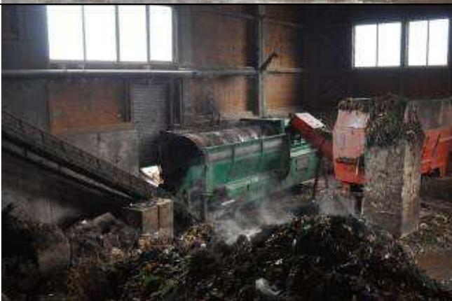
Das Material wird von Schnecken im Tiefbunker vorzerkleinert. In einem riesigen Trommelsieb werden die Anteile, die noch zu groß sind, per Förderband ausgeschieden und wandern nochmals in den Tiefbunker. Der für die Kompostierung geeignete Anteil kommt über ein anderes Förderband durch den Magnetabscheider, der Metallteile herausholt.
