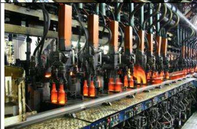
Durch Luftzufuhr entsteht die neue Glasverpackung: die Luft wird hinein geblasen – ähnlich wie bei einem Luftballon.
