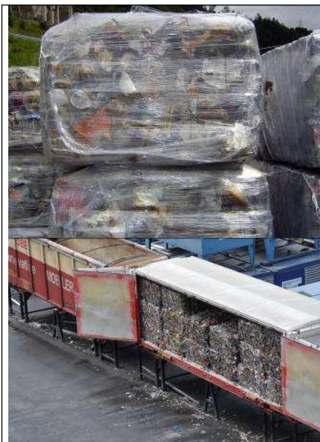
In große Pakete verpackt fährt die mittel- und hochkalorische Fraktion mit der Bahn nach Lenzing (Oberösterreich), wo Papier produziert wird. Um aus dem Holz den Zellstoff rauszulösen braucht man Dampf, der aus riesigen Drehrohröfen kommt. Diese Öfen werden von den gut brennbaren Teile meines Restmülls beheizt.
