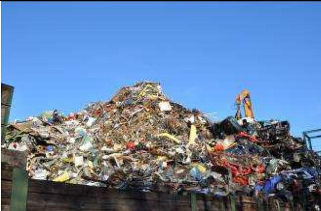
Eine massive Schrottschere zerkleinert dort die größten Teile damit sie über einen riesigen Greifarm in den Zerkleinerer gefüttert werden können. Das Schreddervormaterial kann sehr unterschiedlich sein, je nachdem woher der Schrott kommt.
