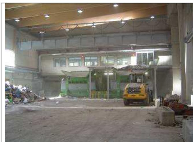
Der Restmüll kommt dann in den Tiefbunker. Es gibt auch einen Bereich in der riesigen Halle der als Flachbunker bezeichnet wird- dort wird der Sperrmüll ausgeladen. Per Bagger wird aus diesem Haufen noch das größte Holz aussortiert.
