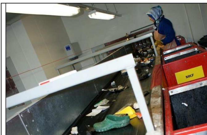
Dies führt zu hoher Reinheit (bis zu 95 %) und hoher Präzision –sogar die kleinsten Partikel werden erkannt. Um auf fast 100% zu kommen, wird hier noch einmal händisch aussortiert. Alles was nicht dazugehört, wie zum Beispiel Gegenstände aus Plastik, die keine Verpackungen sind (so wie Kleiderbügel oder Crocs) kommt noch raus.
