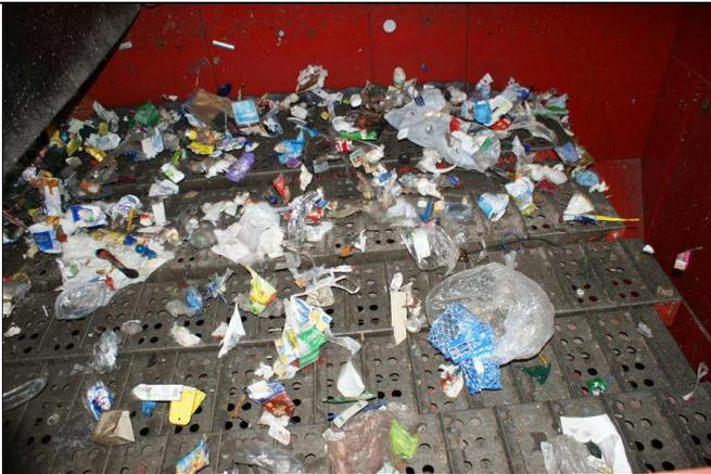
Der Kunststoff kommt durch einen Ballistikseparator, der flächige von volumigen Hohlkörpern trennt. Auf den riesigen Paddeln verhalten sich die Kunststoff-Teile unterschiedlich und können deshalb in leichtere und schwerere getrennt werden.
