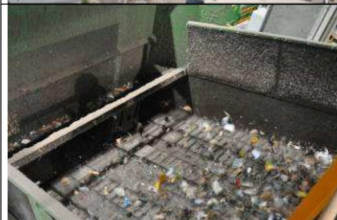
Das größere Material kommt nun zum Ballistikseparator. Dort wird es von sich gegengleich bewegenden Paddeln die Mittelkalorik von der Hochkalorik getrennt. Die Abfallstücke purzeln je nach Gewicht, also entsprechend dem Material aus dem sie sind, vom oberen oder unteren Ende der Paddel. So landet Abfall aus Plastik oder Holz gemeinsam am nächsten Fließband, und leichtere Fetzen und Stücke wie Schaumstoff oder Textilien auf einem anderen Fließband.
