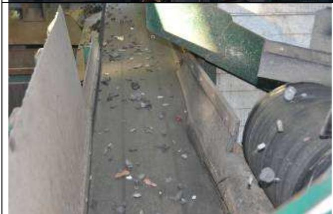
Das metallische Material kommt aus dem Schredder über eine Magnetrolle auf weitere Förderbänder. Das magnetische Eisen wird über die Rolle auf eine eigene Sortierlinie gebracht. Andere Metalle, wie das nicht magnetischen Alu, werden über Induktion, also den schnellen Wechsel von + und – Polung, im Wirbelstorm-Abscheider getrennt.
