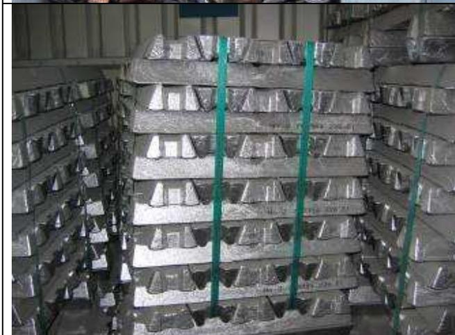
Aluminium zum Beispiel wird wieder zu Barren eingeschmolzen. Recycling-Aluminium ist viel günstiger und energiesparender als aus Rohstoffen gewonnenes Alu.
