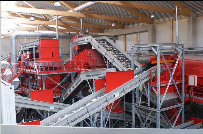
Die Förderbänder (insgesamt 87 Stück!) schicken das Material weiter. Ein Magnetabscheider holt alle Metallgegenstände heraus bevor die Sortierung nach Kunststoff-Art beginnt. Für das Recycling ist nämlich wichtig, dass "sortenrein" getrennt wird. Unterschiedliche Kunststoffe haben unterschiedliche physikalische Eigenschaften, die sich die Anlage zunutzen macht.
