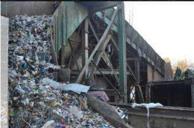
Ein Förderband bringt das zerkleinerte Material in das Herzstück der Anlage: den Schredder. Ein 1300ps Motor hexelt mit massiven Hämmern über eine Abbruchkante alles in maximal faustgroße Stücke. Dieser Vorgang wird mit Kameras und von einem Mitarbeiter ständig überwacht, weil auch bei entsorgten Gasflaschen zum Beispiel Explosionsgefahr herrscht.
