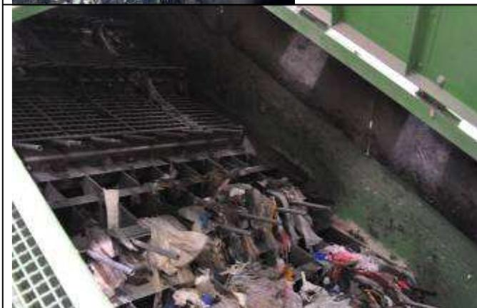
Das zerkleinerte Material kommt über ein Förderband zur ersten Sortierung. Der Abfall purzelt über ein schräges Gitter mit unterschiedlich großen Schlitzen nach unten.
