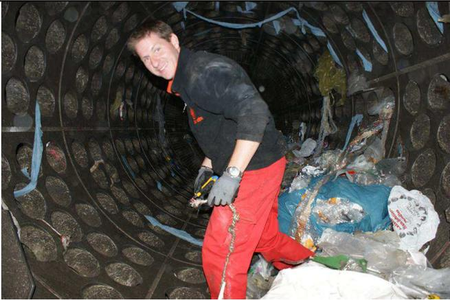
Das nun lose Material wird in einem großen Trommelsieb geschleudert und durch seine physikalischen Eigenschaften getrennt: Folien werden von anderen Hohlkörpern und Plastikgegenständen abgeschieden. Das Trommelsieb sieht aus wie eine große Waschmaschine von innen, nur mit riesigen Löchern. Was nicht im Schleudergang durch die Löcher passt (also die großen Folien), kommt quasi durch die Mitte raus.
